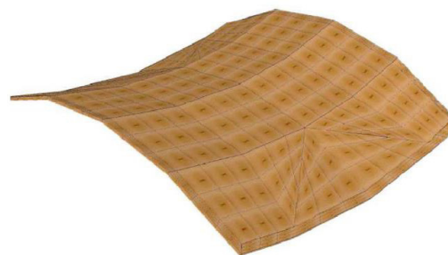
Modelo de la cubierta de madera funcionando como carcasa (gentileza de la empresa Cammi)
